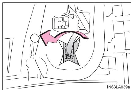
**6** 電球を取りはずす
