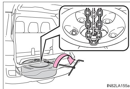
**5 タイヤを巻き上げたら、タイヤが確実に固定されていることを確認する**
