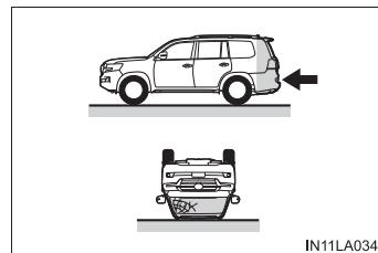
SRS カーテンシールドエアバッグは、後方からの衝撃、縦方向への転覆、または低速での前方や側面からの衝撃では、通常は作動しません。
