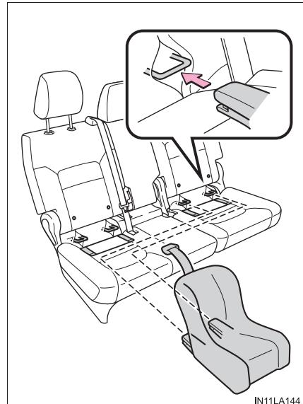
**5** フタを開けて、トップテザーアンカーにフックを固定し、テザーベルトを締める
