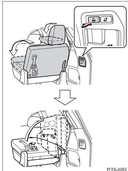
3 シートを側面に押し付けて、確実に固定する
