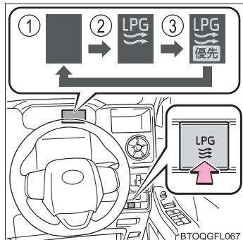
下表を参考に LPG 燃料冷却システムのモードを使い分けてください。
