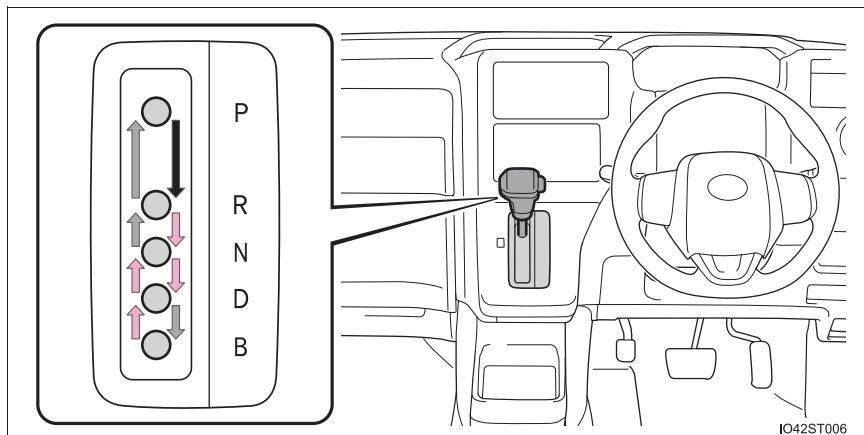
◀ パワースイッチが“ON”の状態で、ブレーキペダルを踏み、シフトレバーボタンを押したまま操作します。
