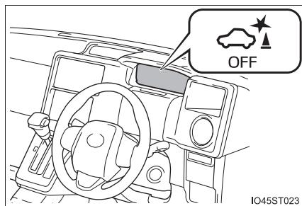
OFF（非作動）に切りかえて、パーキングサポートブレーキ（静止物）を停止させた場合、再度マルチインフォメーションディスプレイの設定画面から ON（作動）に切りかえないといシステムは復帰しません。（パワースイッチの操作では復帰しません）
