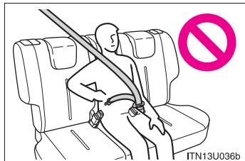
分離格納式シートベルトを使用するときは、必ずプレートAとバックルを結合してください。結合しない状態で使用すると、シートベルトが十分な効果を発揮せず、重大な傷害におよぶか、最悪の場合死亡につながるおそれがあります。
