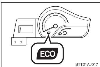
環境に配慮した運転をしているとき、エコドライブインジケーターランプが点灯します。
