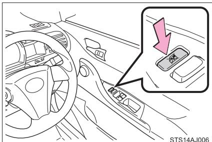
スイッチを押して助手席のドアガラスを作動不可にする。
