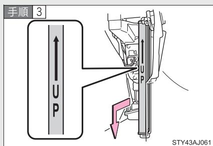
フィルターを取りはずし、新しいフィルターに交換する。
