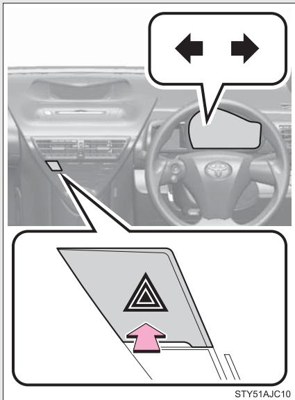
スイッチを押すとすべての方向指示灯が点滅し、もう一度押すと消灯します。
