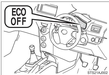
車両が停止するたびにクラッチペダルを操作してもエンジンは停止しません (→P. 164)。
