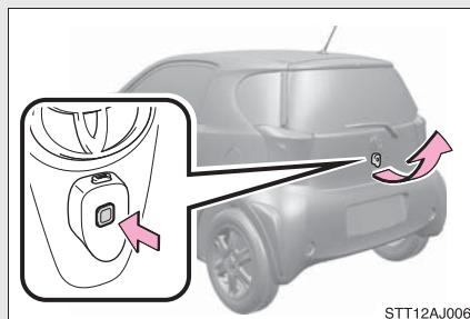
バックドアオープンスイッチを押したまま、バックドアを持ち上げる。
