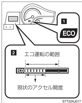
環境に配慮したアクセル操作（エコ運転）の範囲と、現状のアクセル開度を表示します。エコ運転中は、エコドライブインジケーターランプ（1）が点灯します。
