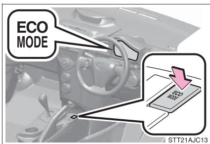
エアコンの性能を抑え、燃費を向上させる走行に適しています。スイッチを押すと、メーター内の ECO MODE 表示灯が点灯します。
