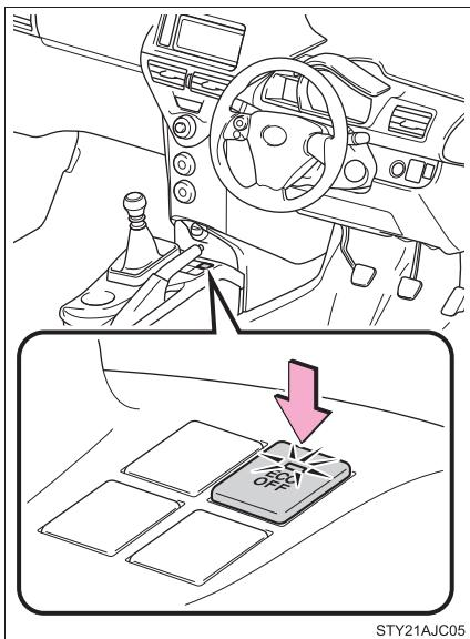
Stop & Start システムを非作動にするために ECO OFF スイッチを押してください。
