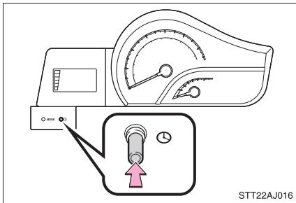
**手順 1]** クロックセットボタンを押し続けて、分表示を点滅させる。
