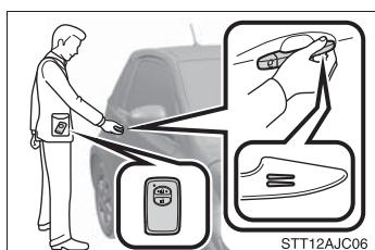
ドアハンドル上側のロックセンサー部に触れても施錠できないときは、上下のロックセンサー部に同時に触れてください。
