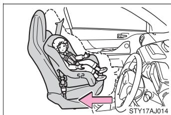
●やむを得ず助手席に前向きにチャイルドシートを取り付ける場合には、助手席をいちばん後ろに下げて取り付けてください。助手席 SRS エアバッグはかなりの速度と力でふくらむので、お守りいただかないと、重大な傷害を受けたり、最悪の場合死亡につながるおそれがあります。
