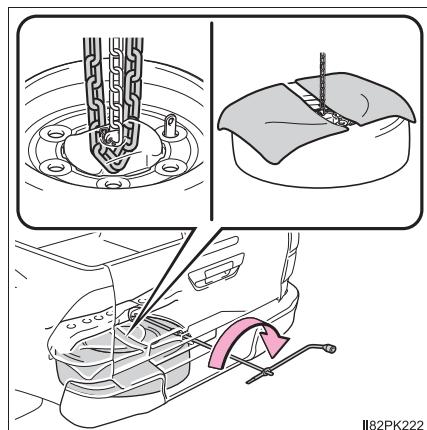
**3** タイヤを巻き上げたら、タイヤが確実に固定されていることを確認する
