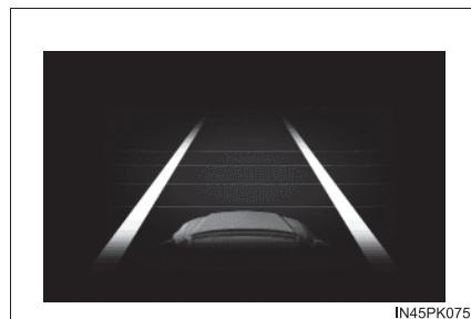
システムが白（黄）線または走路※を認識していることを示しています。車両が車線から逸脱した場合、逸脱している側の白線表示が黄色で点滅します。
