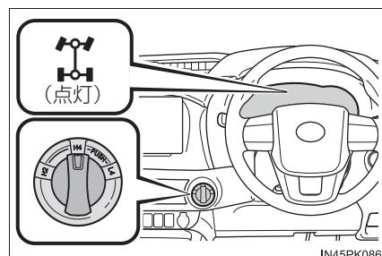
停車状態でトランスファースイッチの操作をしたとき、4WD 表示灯が点滅したままになる場合があります。次のいずれかの操作を行ってください。
