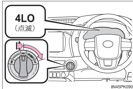
L4 作動表示灯の点滅中にシフトレバーを N 以外に入れると、ギヤ鳴りが発生します。ただちにシフトレバーを N にして、切りかえが完了するまでお待ちください。
