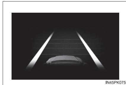
システムが白（黄）線または走路<sup>※</sup>を認識していることを示しています。車両が車線から逸脱した場合、逸脱している側の白線表示が黄色で点滅します。
