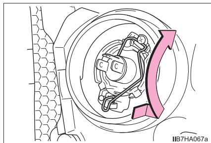
**9** 電球を取りはずす
