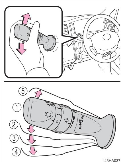
間欠作動 (
