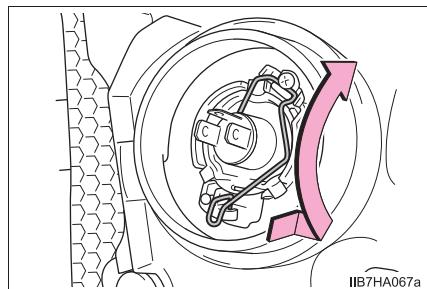
**9** 電球を取りはずす
