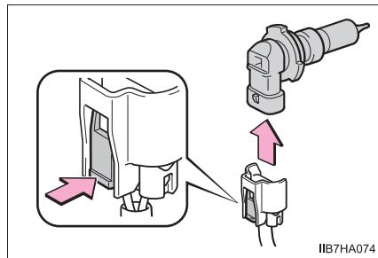
**4** 電球を交換し、ソケットを取り付ける
