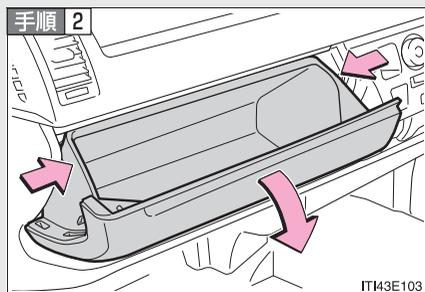
グローブボックスを開き、グローブボックス側面を内側に押し、上部のツメを片側ずつはずし、下部のツメをはずして取りはずす
