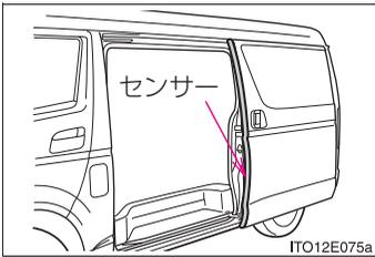
スライドドアを自動で閉めているときに、センサーが異物の挟み込みなどを感知すると、スライドドアが反転作動し、全開位置で自動停止します。
