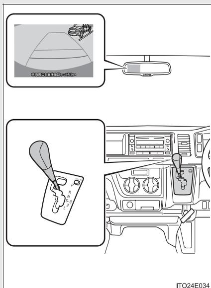
エンジンスイッチが“ON”のとき、シフトレバーをRにすると、バックモニターの画面が表示されます。
