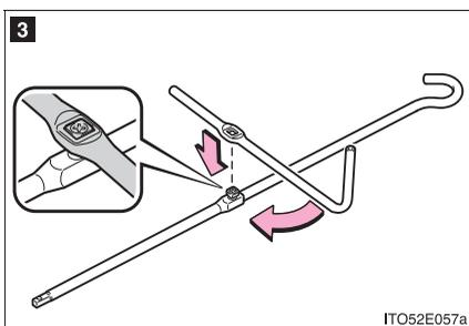
**3** ジャッキハンドルの穴部を使い、接続用ボルトを締め付ける
