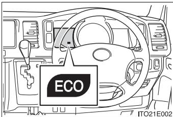
環境に配慮した運転をしているとき、エコドライブインジケータランプが点灯します。
