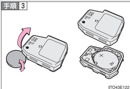
コインなどを使用してモジュールカバーをはずし、消耗した電池を取り出す
