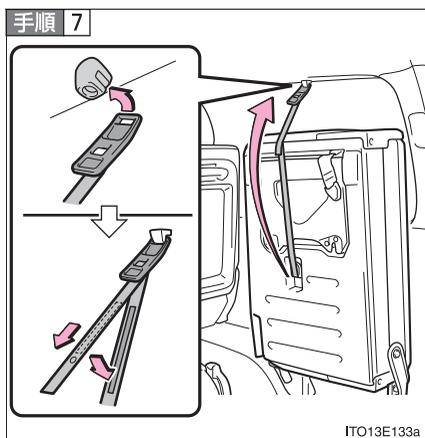
プレートをフックに掛けてから、バンドの端を引いてたるみをなくし、シートを確実に固定する
