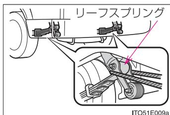
緊急時、一般路上で故障した他車（故障車）※をやむを得ずけん引するときは、リーフスプリング部分にロープをかけます。
