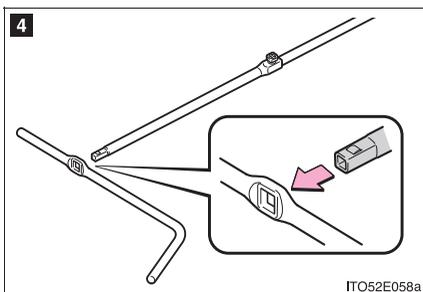
**4** ジャッキハンドル延長用バーをジャッキハンドルの穴部に確実に挿し込む
