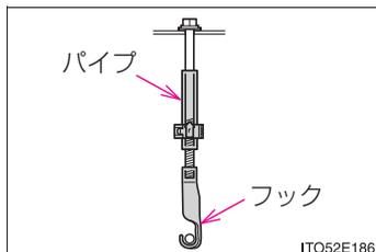
スペアタイヤ格納具を降ろす際に、ボルトをゆるめすぎてフックが脱落した場合は、図のようにパイプが入っているのを確認してからフックを取り付けてください。
