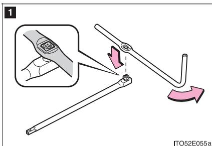
**1** ジャッキハンドルの穴部を使い、ジャッキハンドル延長用バーの接続用ボルトをゆるめる
