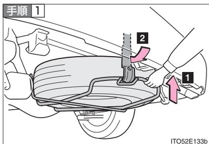
スペアタイヤ格納具にタイヤを載せて持ち上げ（**1**）、フックを掛けてボルトを締め付ける（**2**）
