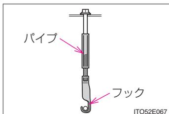
スペアタイヤ格納具を降ろす際に、ボルトをゆるめすぎてフックが脱落した場合は、図のようにパイプを入れてからフックを取り付けてください。
