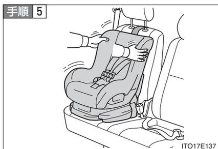
取り付けたチャイルドシートを軽くゆさぶり、確実に固定されていることを確認する
