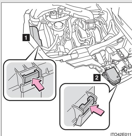
エンジン点検口(→P. 234)を開けて、ツメを押しながら、カバーを持ち上げる
