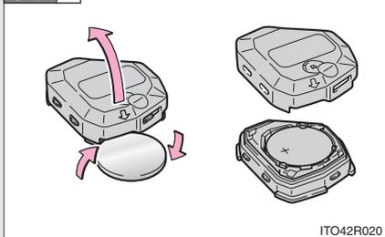
コインなどを使用してモジュールカバーをはずし、消耗した電池を取り出す
