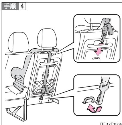
トップテザーアンカーにフックを固定し、テザーベルトを締める
