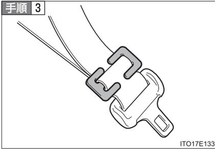
チャイルドシートにシートベルトの固定機構が備わっていない場合は、ロックングクリップ（別売）を使用して固定する
