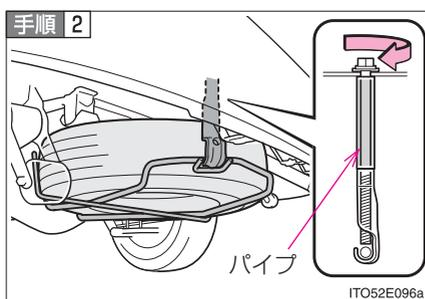
パイプががたつかなくなるまでボルトを締め付けたあと、さらに1/4回転以上締め付ける
