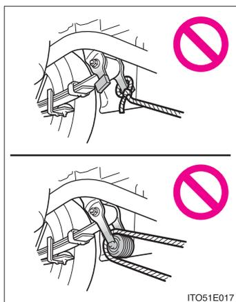
図のようなリーフスプリング付きの車両は、図に示す部分でのけん引は絶対にしないでください。破損し、その破片が周囲の人などにあたり、重大な傷害におよぶか、最悪の場合死亡につながるおそれがあります。
