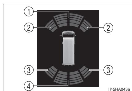
静止物を検知しているときに、クリアランスソナー検知表示灯が点灯します。 (→ P. 60)
