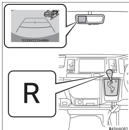
エンジンスイッチが“ON”（スマートエントリー＆スタートシステム非装着車）またはイグニッション ON モード（スマートエントリー＆スタートシステム装着車）のとき、シフトレバーを R にすると、バックモニターの画面が表示されます。
