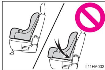
※3 ヘッドレストとチャイルドシートが干渉してチャイルドシートが正しく取り付けられない場合、ヘッドレストの取りはずしが可能なときは、ヘッドレストを取りはずしてください。
