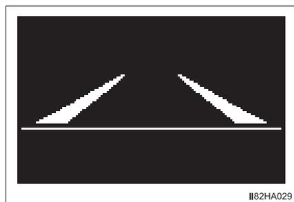
システムが白（黄）線を認識していることを示しています。車両が車線から逸脱した場合、逸脱している側の白線表示が点滅します。
