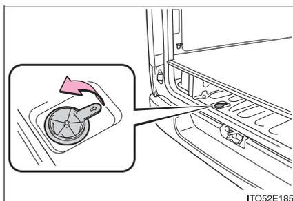
マットの切り欠き部分をめくり、床下収納 (→ P. 329) のカバーをはずして、キャップをはずす
