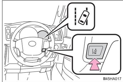
エンジンスイッチを“ON”（スマートエントリー&スタートシステム非装着車）、またはイグニッションONモード（スマートエントリー&スタートシステム装着車）にするたびにLDAはONになります。
