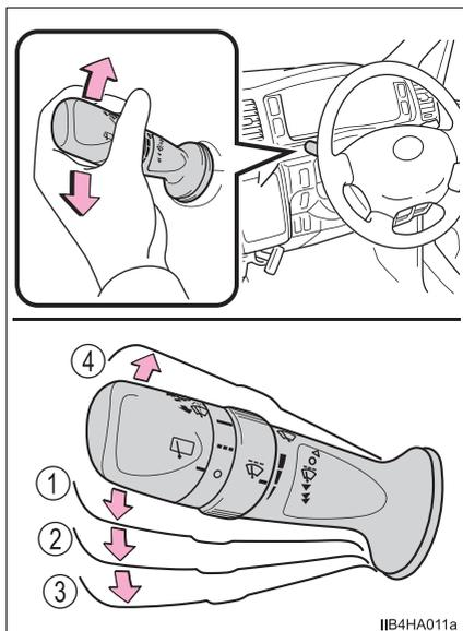
間欠作動を選択しているとき、間欠時間を調整することができます。（間欠時間調整式ワイパー装着車）
