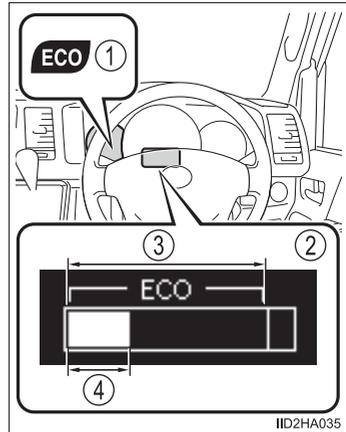
アクセル操作に連動してバー表示が変化します。
