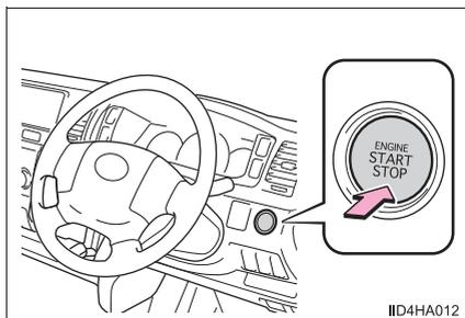
ディーゼル車：
