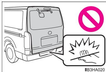
●ロックレバーが施錠側のときは、イージークローザー作動中に車内のドアハンドルを操作しても作動は停止しません。指などを挟まれないように注意してください。骨折など重大な傷害を受けるおそれがあります。
