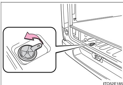
マットの切り欠き部分をめくり、床下収納 (→ P. 279) のカバーをはずして、キャップをはずす
