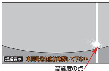
※スミア現象：高輝度の点（車体に反射した太陽等）がカメラに映るとその点の上下（縦方向）に尾を引く現象。
