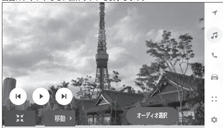
[⏮]: 再生中のファイルの先頭から再生します。ファイルの先頭のときは、前のファイルの先頭から再生します。
