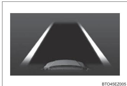
システムが白（黄）線を認識していることを示しています。車両が車線から逸脱した場合、逸脱している側の白線表示が橙色で点滅します。
