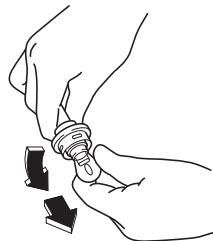
ソケットからバルブを取り外し、新品のバルブと交換する。
