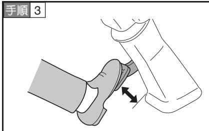
クラッチペダルをゆっくり離しクラッチのつながる直前の状態（エンジン音が変化したり、振動が発生したりする）でペダルと床板（カーペットをめくった状態）とのすきまが基準値の範囲にあるか点検する。
