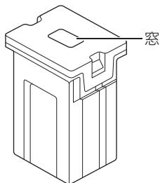
ヒュージブルリンク本体にある「窓」から溶断がないかを点検します。
