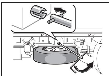
**手順 3** おろしたスペアタイヤ / 応急用タイヤからアンカーブレートをはずす。
