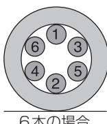
● ホイールナットを対角線上に 2 ~ 3 回に分けて締め付ける。
