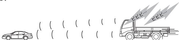
衝突の可能性が高いとコンピュータが判断したとき、警報と弱いブレーキでドライバーへ注意を促すと共に、ストップランプを点灯し後続車へも注意を促す
