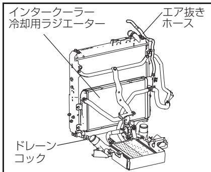
**手順 2** インターチューラー冷却用ラジエーターのドレーンコックを開けます。
