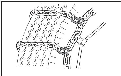
\* タイヤチェーンは、コネクターの折り曲げ部がタイヤの外側に向くよう取り付けます。
