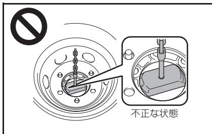
ツメをホイールの穴にかけてアンカープレートを取り付け、ジャッキハンドルをまわして鎖のたわみをなくす。
