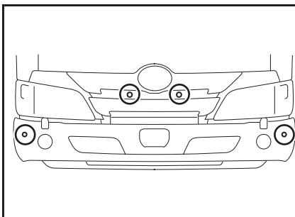
ソナーセンサーに著しく汚れ、水滴、雪などが付着した場合は、取り除いてください。お手入れをする際は、ソナーセンサーを傷付けないよう、やわらかい布を使ってください。汚れが落ちにくい場合は、ホース洗車などで付着物を取り除いてください。
