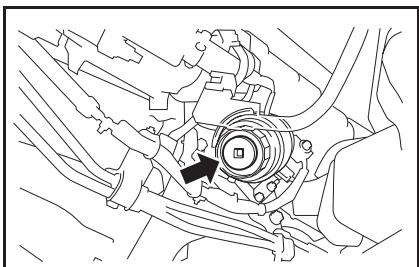
**手順 3** ホースに取り付けたパイプをキャップに差し込む。
