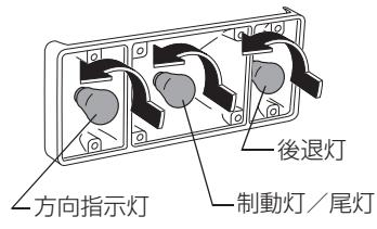
バルブを取り外し、新品のバルブと交換する。
