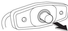
バルブを取り外し、新品のバルブと交換する。
