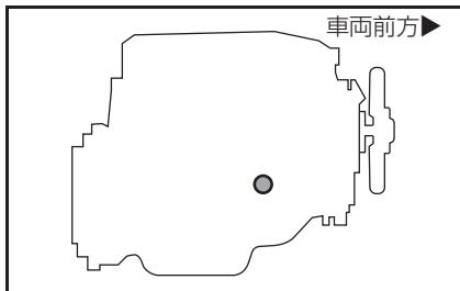
**手順 3** リザーブタンク内の冷却水を排水する。
