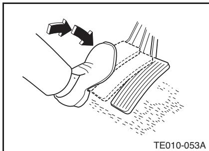
\* 「D」位置で走行中、アクセルペダルをいっぱいに踏み込むと、自動的にシフトダウンし、加速力が大きくなります。
