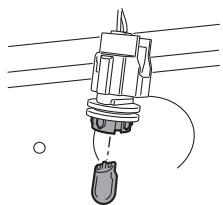
バルブを取り外し、新品のバルブと交換する。
