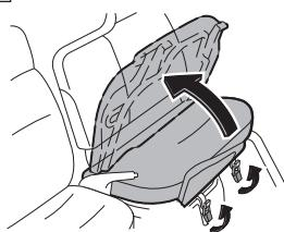
フロアマットをめくり助手席足元にあるレバー2カ所のロックを外し、エンジン点検口をシートごと持ち上げる。
