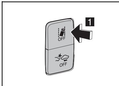
**1** スイッチを押すごとに車線逸脱警報装置のONとOFFが切り替わります。
