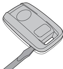
凹部にドライバーを差し込み、カバーを外す。
