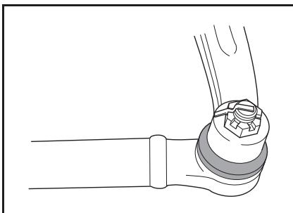
リンク連結部のダストカバーに摩耗や損傷および外れがないかを点検します。
