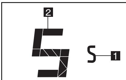
チェンジレバー位置、またはシーケンシャルスイッチにて設定した最高変速ギヤ段数を表示します。
