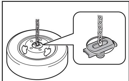
ホイール穴にアンカープレートを取り付け、ジャッキハンドルをまわして鎖のたわみをなくす。
