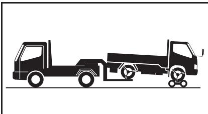
台車を使用して前輪を持ち上げる。
