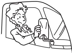
後方や側方および直前・直左の状況が十分に確認できるように、各ミラーを調整する。
