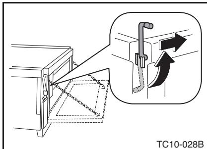
左右のレバーを上に回し内側に押し込んでロックを外すとテールゲートが開きます。
