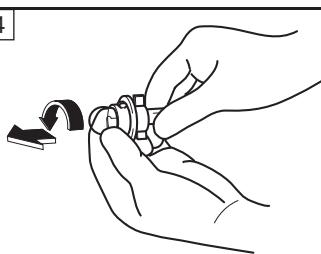
ソケットからバルブを取り外し、新品のバルブと交換する。
