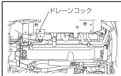
\* 安全のため、地面を汚さないためにも、冷却水は必ず容器に受けてください。
