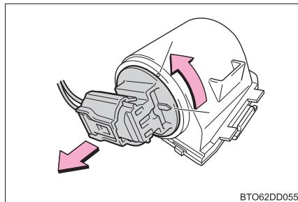
**8** 電球を取りはずす
