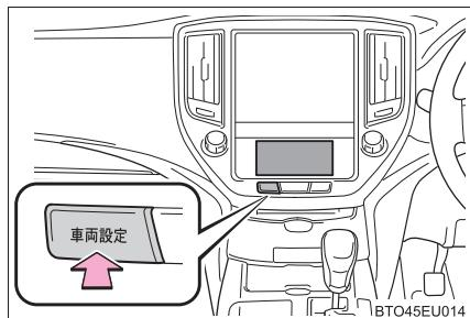
**5 「設定」を選択し、タイヤ空気圧警告灯が 3 回点滅するまで「SET」(リセットスイッチ) を押し続ける**
