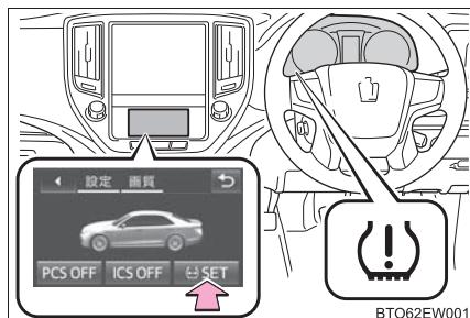
**6 パワースイッチを ON モードにしたまま数分※待ち、その後パワースイッチを OFF にする**
