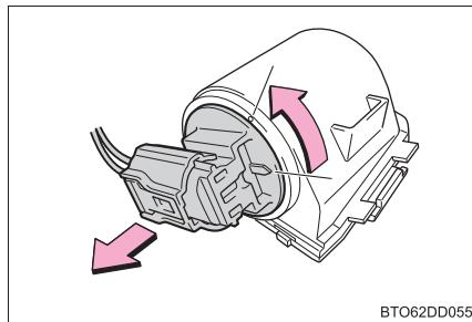
**8** 電球を取りはずす
