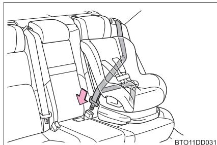
チャイルドシートに付属の取扱説明書に従い、シートベルトをチャイルドシートにしっかりと固定させてください。
