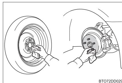
**[2] 応急用タイヤを取り付け、タイヤががたつかない程度まで手でナットを仮締めする**
