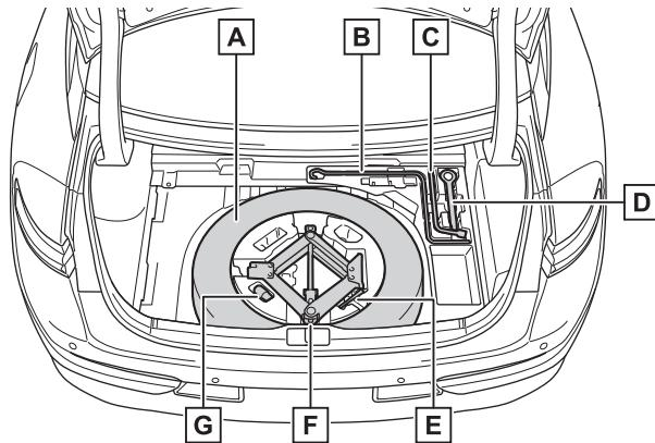
タイヤ交換に必要な工具類は車に搭載されています。
