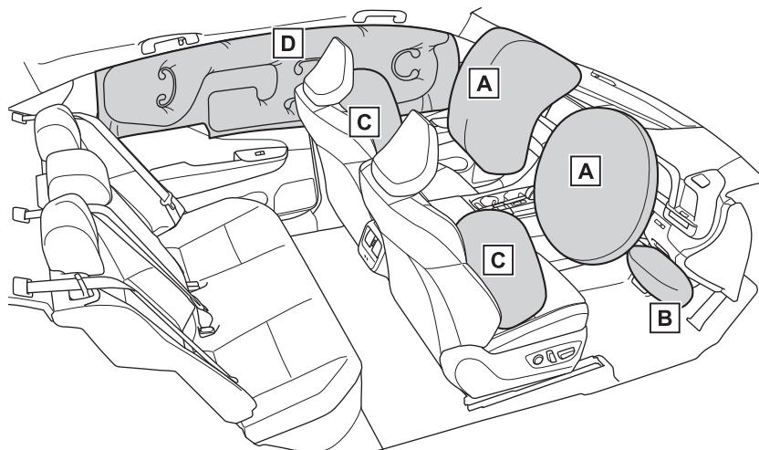
**A** フロント SRS エアバッグ（運転席 SRS エアバッグ／助手席 SRS エアバッグ）
