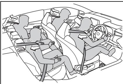
前方・側方から強い衝撃を受けたとき、シートベルトを引き込むことで適切な乗員拘束効果を確認します。
