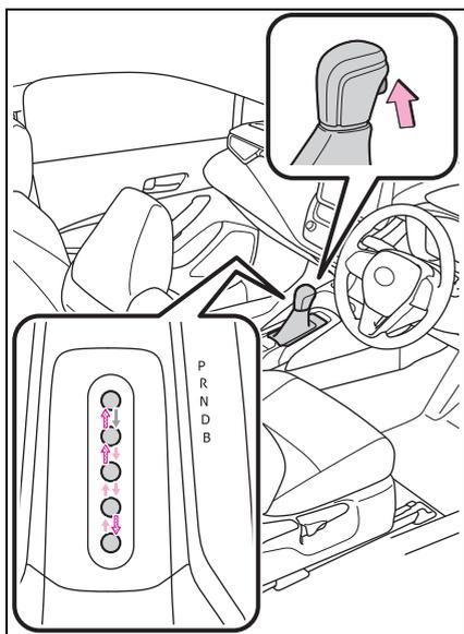
←: パワースイッチが ON の状態で、ブレーキペダルを踏んだままシフトレバーのボタンを押しながら操作します。\*
