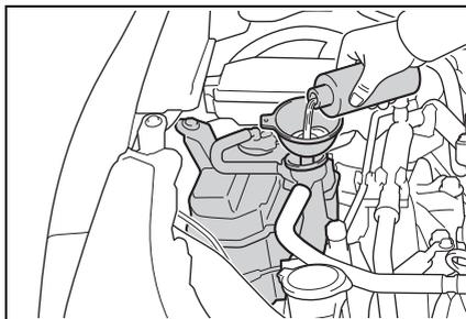
**6** ハイブリッドシステムを始動し、エアコンを作動させてラジエーター冷却用のファンが作動しているか、およびラジエーターコアやホースなどから冷却水もれがないことを再度確認する
