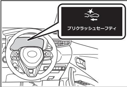
アクセルが強く踏み込まれているとシステムが判断した場合は、図で示すアイコンとメッセージがマルチインフォメーションディスプレイに表示されます。
