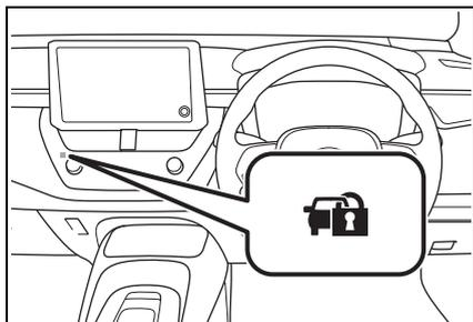
パワースイッチを OFF にすると、システムを作動させるためにインジケーターが点滅します。
