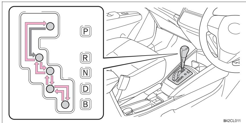
← パワースイッチが ON モードの状態で、ブレーキペダルを踏んだまま操作します。
