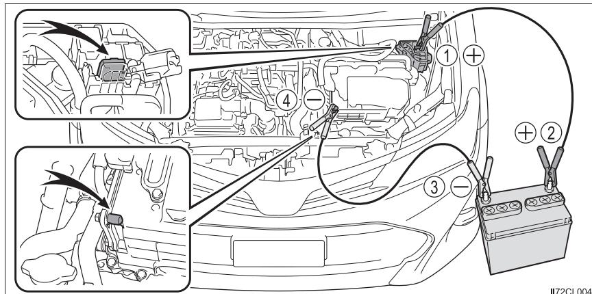
**4** 救援車のエンジンをかけ、回転を少し高めにして、約5分間自車の補機バッテリーを充電する
