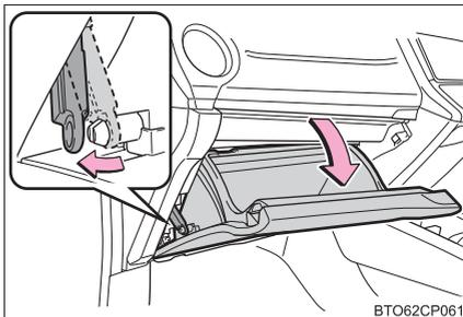
3 グローブボックス側面を内側に押し、上部のツメを片側ずつはずし、下部のツメをはずして取りはずす
