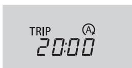
リセットしてからのアイドリングストップ時間 (Stop & Start システムによるエンジン停止時間) を通算で表示します。
