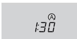
エンジンスイッチを“ON”★、またはイグニッション ON モード★にしてからのアイドリングストップ時間 (Stop & Start システムによるエンジン停止時間) を表示します。
