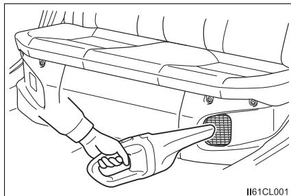
マルチインフォメーションディスプレイに「駆動用電池の冷却部品のメンテナンス必要 取扱書を確認」が表示されたときは、フィルターが目づまりしていることが考えられます。フィルターを清掃してください。
