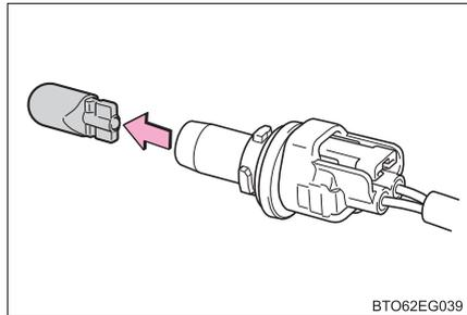
3 新しい電球を取り付け、ソケットをまわして取り付ける
