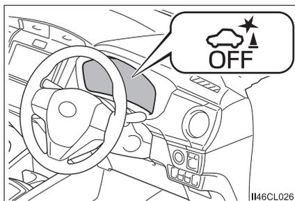
OFF（非作動）に切りかえて、パーキングサポートブレーキ（静止物）を停止させた場合、再度、マルチインフォメーションディスプレイの設定画面からON（作動）に切りかえないとシステムは復帰しません。（エンジンスイッチ★またはパワースイッチ★の操作では復帰しません）
