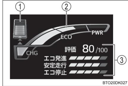
運転の状況を、エコ発進・安定走行・エコ停止の3パターンに分け、5段階で表示します。また、車両が停止するたびに点数を表示します。(発進するごとにリセットされ、積算は行いません)
