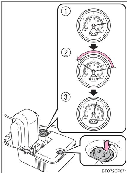
**15** コンプレッサーのスイッチが “OFF” であることを確認した上で、アクセサリソケットから電源プラグを抜き、バルブからボトルのホースを取りはずす
