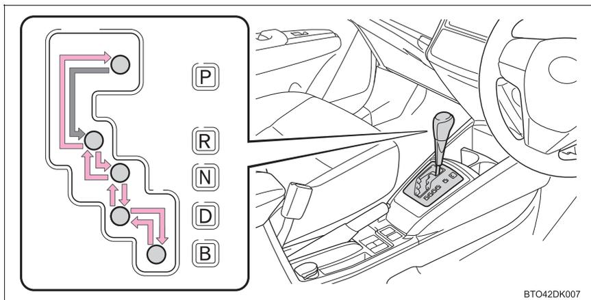
← エンジンスイッチ★が“ON”またはパワースイッチ★が ON モードの状態、ブレーキペダルを踏んだまま操作します。
