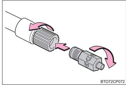
24 ボトルとコンプレッサーを接続したままトランク内に収納する
