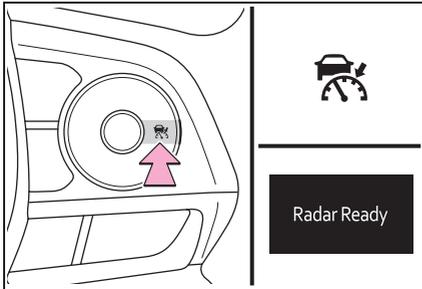
**2** 希望の车速 (約 30km/h 以上) までアクセルペダル操作で加速／減速し、“-SET” スイッチを押して速度を設定する
