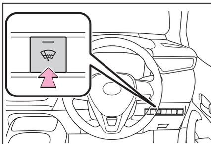
フロントウインドウガラスとワイパーブレードの凍結を防ぐために使用ください。
