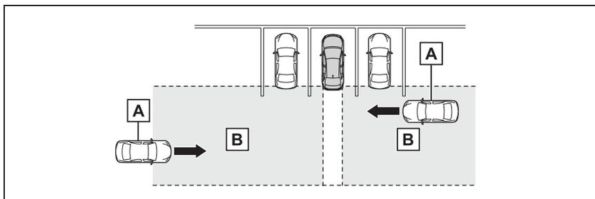
**A** 接近車両**B** 接近車両を検知できる範囲
