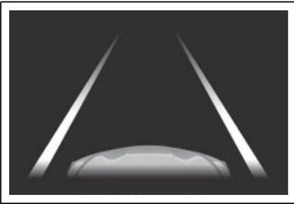
システムが白（黄）線または走路※を認識していることを示しています。車両が車線から逸脱した場合、逸脱している側の白線表示が橙色で点滅します。
