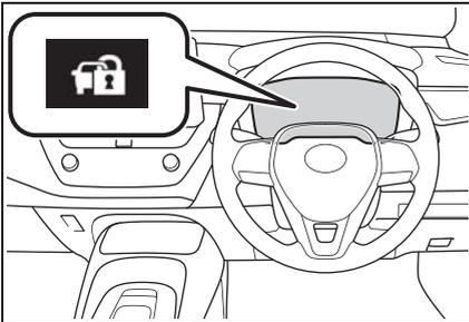
エンジンスイッチを OFF にすると、システムの作動を知らせるためにインジケーターが点滅します。
