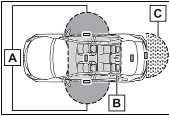
**A** ドアの施錠・解錠時 (スマートエントリーシステム装着車)
