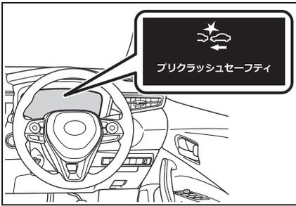
アクセルが強く踏み込まれているとシステムが判断した場合は、図で示すアイコンとメッセージがマルチインフォメーションディスプレイに表示されます。
