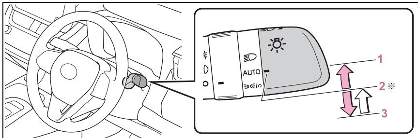
\* スイッチを **3 シールド** の位置へ操作し手を離すと、自動的に **2 AUTO** の位置へ戻ります。
