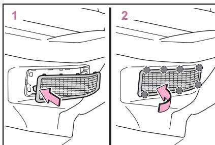
1 吸入口カバー右端のツメを差し込む
