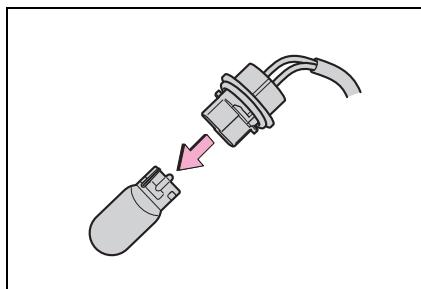
7 新しい電球を取り付け、ソケットをランプ本体に挿し込み右にまわして取り付ける
