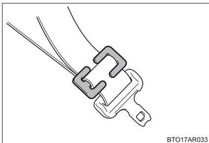
チャイルドシートにシートベルトの固定装置が備わっていない場合は、ロックングクリップ（別売）を使用してシートベルトにゆるみが生じないようにしっかりと固定する。
