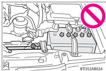
バッテリー液補充口のキャップをラジエーターの近くに置かないでください。キャップに付着したバッテリー液によりラジエーター部品が損傷するおそれがあります。
