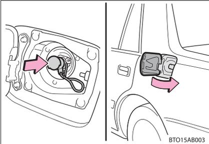
補給口にビニールキャップを付けて、補給口のフタを閉める
