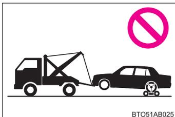
車両の損傷を防ぐために図のようなレッカー車ではけん引しないでください。
