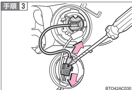
図の位置にマイナスドライバーを挿し込んで、ソケットを取りはずす
