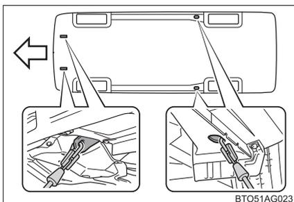
車両運搬車で輸送するときは、図の場所で固縛する
