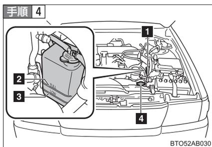
冷却水の量がリザーバータンクの“FULL” (上限) と “LOW” (下限) のあいだにあるかを点検する
