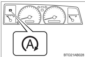
Stop & Start はエンジン スイッチを操作することなくエンジンを停止・始動させるシステムです。Stop & Start によるエンジンの停止中、Stop & Start 表示灯（緑色）が点灯します。（→P. 92）
