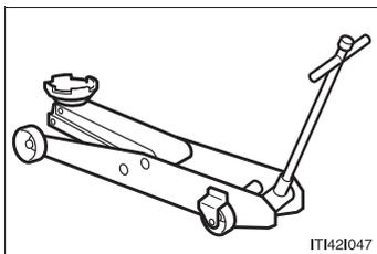
● 図のようなガレージジャッキを使用して車両を持ち上げる。
