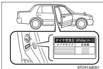
タイヤの空気圧は、運転席側のタイヤ空気圧ラベルで確認することができます。
