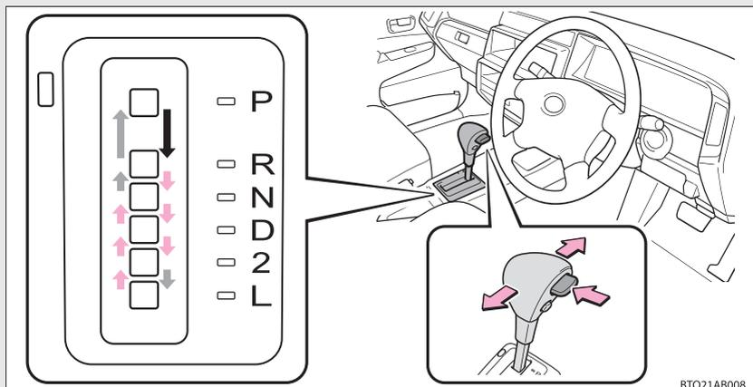
← エンジン スイッチが “ON” のときで、ブレーキペダルを踏み、シフトレバーボタンを押したまま操作します。
