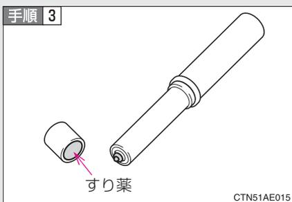
先端のフタを取り、すり薬と発炎筒の先端をこすり、着火させる
