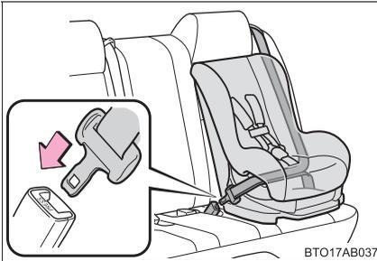
チャイルドシートにシートベルトを取り付け、プレートをバックルに“カチッ”と音がするまで挿し込む。ベルトがねじれていないようにする。
