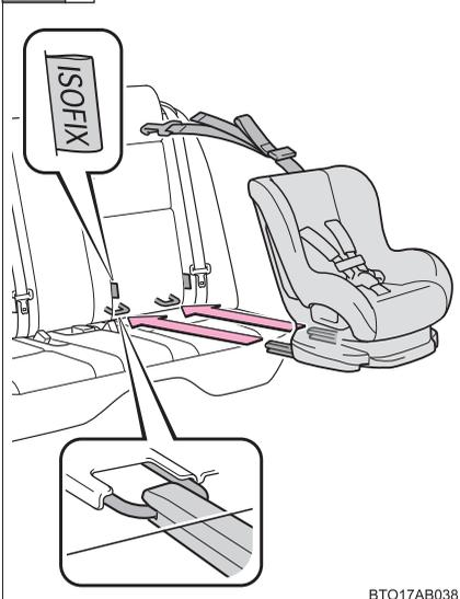
固定専用バーの位置を確認して、チャイルドシートをシートに取り付ける
