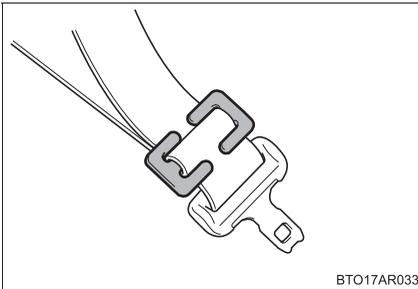
チャイルドシートにシートベルトの固定装置が備わっていない場合は、ロックングクリップ（別売）を使用してシートベルトにゆるみが生じないようにしっかりと固定する。
