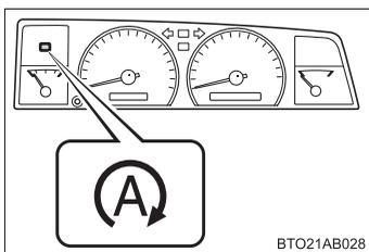
Stop & Start はエンジン スイッチを操作することなくエンジンを停止・始動させるシステムです。Stop & Start によるエンジンの停止中、Stop & Start 表示灯（緑色）が点灯します。（→P. 90）
