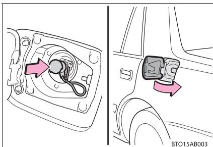
補給口にビニールキャップを付けて、補給口のフタを閉める
