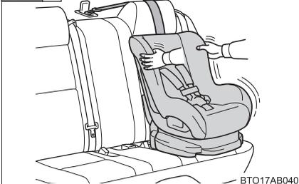
取り付けしたチャイルドシートを前後左右にゆすり、確実に取り付けられていることを確認する
