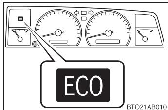
Stop & Start システムはエンジン スイッチを操作することなくエンジンを停止・始動させるシステムです。Stop & Start システムによるエンジンの停止中、アイドルトップ表示灯が点灯します。（→P. 80）
