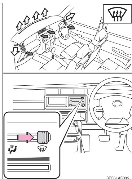
吹き出し口切りかえレバーを 、内外気切りかえレバーを 、ヒーター調整レバーを ホットゾーンにする
