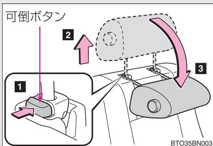
ヘッドレストをいちばん上まで引き上げたあと、可倒ボタンを押して、さらに引き上げ、ヘッドレストを前に倒します。
