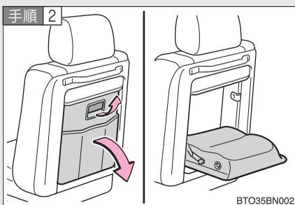
レバーを引き上げ、背もたれの中央部を後方へ倒す
