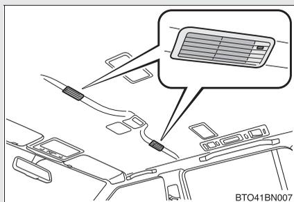
作動している吹き出し口の作動表示灯が点灯します。
