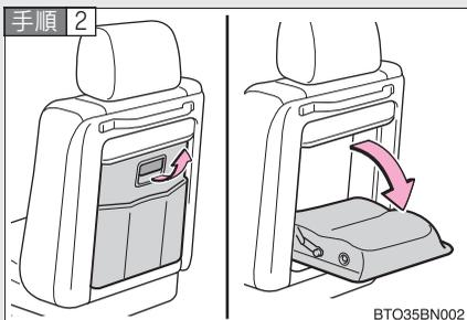
レバーを引き上げ、背もたれの中央部を後方へ倒す
