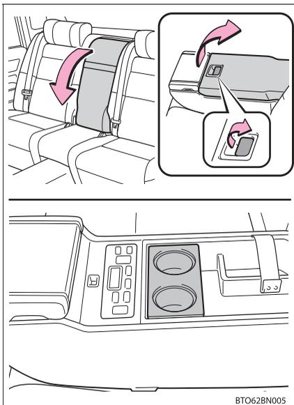
リヤセンターアームレストを倒し、レバーを引いてカバーを上げる
