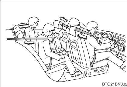
前方から強い衝突を受けたとき、シートベルトを巻き込むことで適切な乗員拘束効果を確認します。
