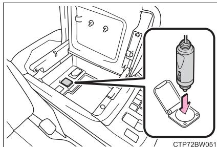
**9** コンプレッサーにボトルを接続する
