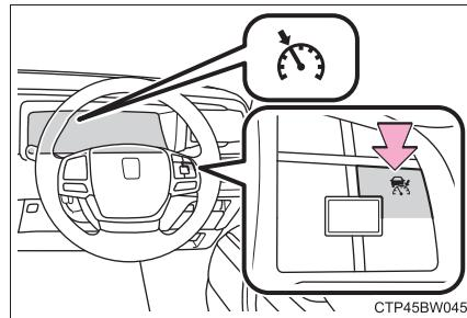
システムが OFF の状態から操作したときのみ、定速制御モードへの切りかえが可能です。
