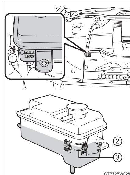
**5** 冷却水が不足している場合は、冷却水を補給する(→P. 472)
