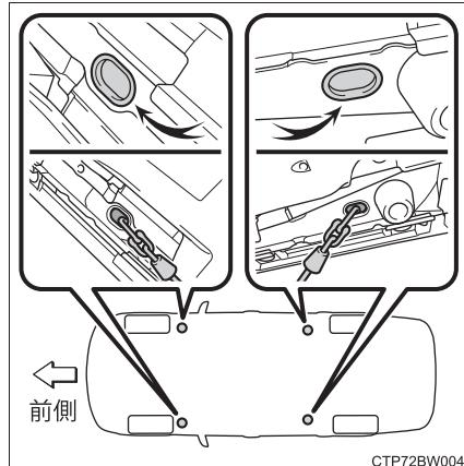
鎖やケーブルなどを使用して車両を固縛する場合は図に黒く示す角度が45°になるように固縛する
