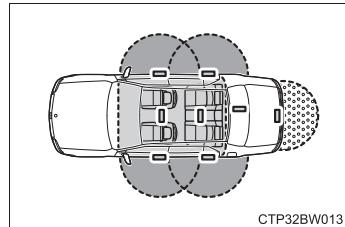
トランクオープنسイッチから周囲約 70 cm 以内で電子キーを携帯している場合に作動します。
