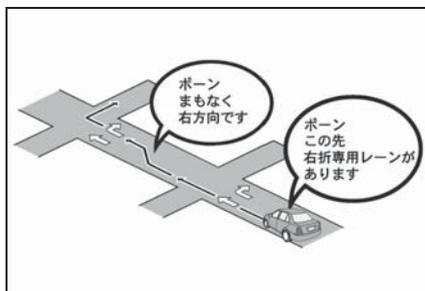
直進する交差点に右折（左折）専用レーンがある場合、その交差点に近づくと「この先 右折（左折）専用レーンがあります」と音声案内されます。目的地案内中で、右折（左折）する交差点では右折・左折専用レーン案内はされません。この場合は「ポーン まもなく右方向（左方向）です」と音声案内されます。
