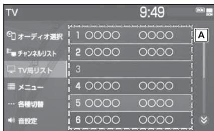
**A** 選択したチャンネルを受信します。長押しすると、受信中のチャンネルを記憶します。
