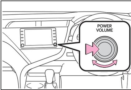
“POWER VOLUME” / “PWR・VOL” ノブ：押すごとに電源の ON と OFF が切り替わります。回すと音量が切り替わります。
