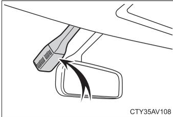
フロントウィンドウガラスの曇り検知（→P. 209）のために、フロントウィンドウガラスの温度やその付近の湿度などを監視するセンサーが装着されています。
