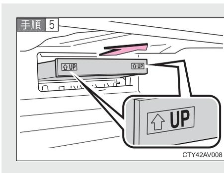
フィルターを取りはずし、新しいフィルターと交換する
