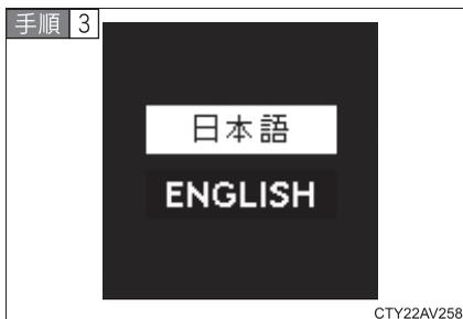
DISP スイッチを押して設定したい項目を選択し、DISP スイッチを長押しする
