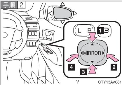
スイッチを押してミラーの鏡面を調整する
