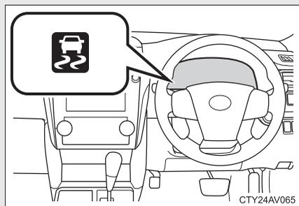
車両が完全に停止している状態で、さらにブレーキペダルを踏み込むとヒルスタートアシストコントロールは作動します。
