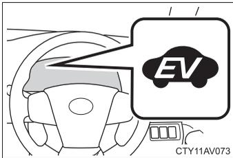
電気モーターの動力のみで走行しているときは、EV インジケーターが点灯します。
