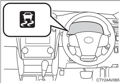
TRC・VSC・ABS が作動しているときは、スリップ表示灯が点滅します。
