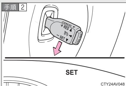
希望の速度まで加速／減速し、レバーを下げた速度設定する
