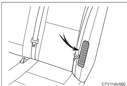
リヤシート横（左側）部には、駆動用電池冷却用の吸入口があります。吸入口をふさいだりすると、駆動用電池の過熱や出力低下の原因になります。
