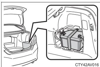
この車両の補機バッテリーはラゲージルーム（運転席側）のカバー内にあり、エンジンルームには搭載されていません。（補機バッテリーはバッテリー液の補充が必要ないタイプのため、バッテリー液量などの点検は不要です）
