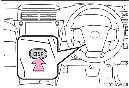
“DISP” スイッチを押し、エネルギーモニターを表示させる
