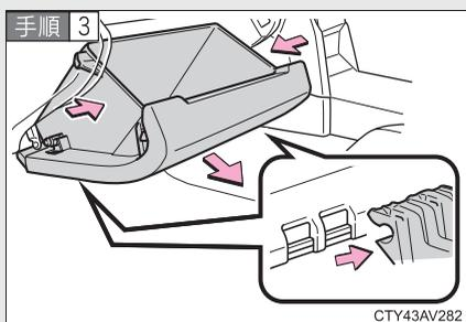
グローブボックス側面を内側に押し、上部のツメを片側ずつはずし、下部のツメをはずして取りはずす
