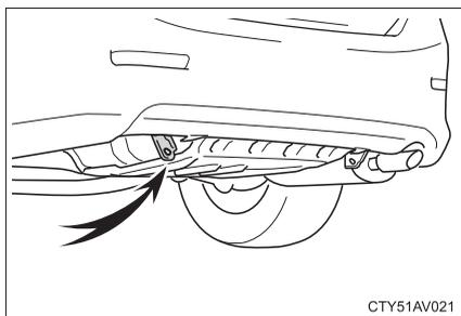
リヤの固縛用フックを緊急用フックとしても使用できます。雪の吹きだまりなどでスタックして走行できなくなったときに緊急的に他車に引っ張り出してもらうときに使用するものです。他車をけん引することはできません。
