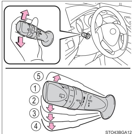
AUTO モード（AUTO）が選択されているときは、次のようにツマミをまわして雨滴センサーの感度を調整できます。
