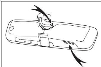
・洗車時に高圧洗浄機でカメラやカメラ周辺に直接水をあてないでください。強い水圧により衝撃が加わり、装置が正常に作動しなくなるおそれがあります。
