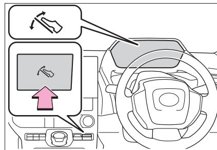
回生ブーストスイッチを押すと、アクセルペダルを離したときの回生ブレーキ力が通常よりも強い状態になります。
