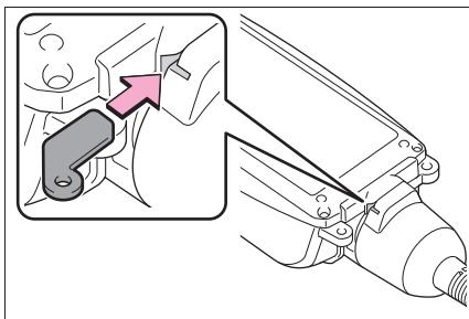
**5 コントロールユニットの解除穴に解除キーを奥まで挿し込んだまま、電源プラグコードのナット部をまわして、電源プラグコードを取りはずす**
