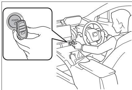
**3 ブレーキペダルをしっかりと踏み込んで、マルチインフォメーションディスプレイに が表示されていることを確認する。**
