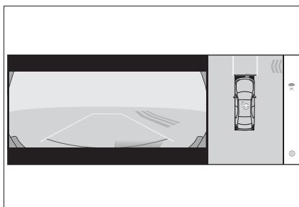
“ピッ”という音が鳴り、マルチインフォメーションディスプレイに作動中のメッセージを表示して、アシストが開始されます。
