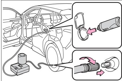
**21** コンプレッサーのスイッチを数秒間 ON にしてから再度 OFF し、空気圧を確認する
