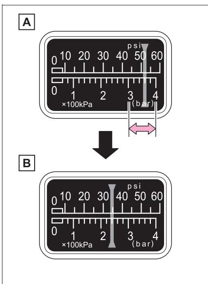
**A**一時的に空気圧計が 300～400kPa (3.0～4.0kg/cm<sup>2</sup>) まで上昇し、徐々に減少します。
