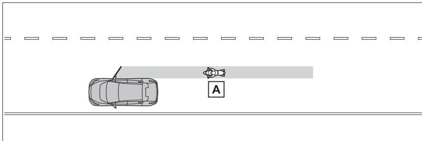
**A** ドア（バックドアを除く）を開けたときにドアと衝突する可能性が高いと判断された車両・自転車
