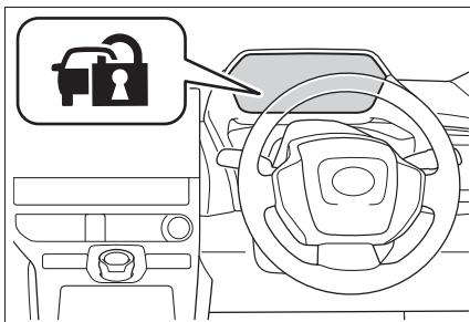
パワースイッチをOFFになると、システムの作動を知らせるためにセキュリティ表示灯が点滅します。
