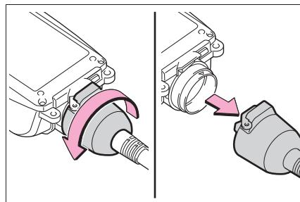
**6 コントロールユニット接合部の突起と、電源プラグコードコネクターの溝とを合わせて挿し込み、電源プラグコードのナット部をまわして取り付ける**
