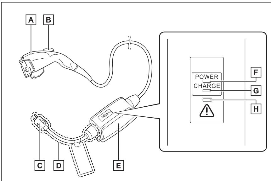
**A** 普通充電コネクター**B** ロック解除ボタン**C** 電源プラグ**D** 電源プラグコード\***E** コントロールユニット**F** 電源インジケーター（→P.69）**G** 充電インジケーター（→P.69）
