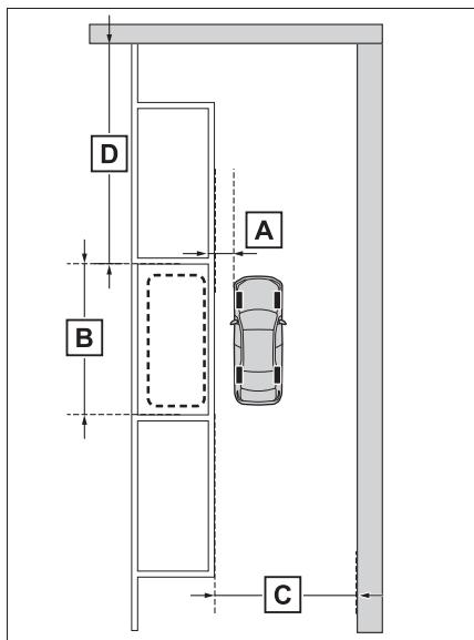
**A** 約 1m\***B** 約 5 ~ 6m\***C** 約 4.5m 以上 \***D** 約 8m 以上 \*
