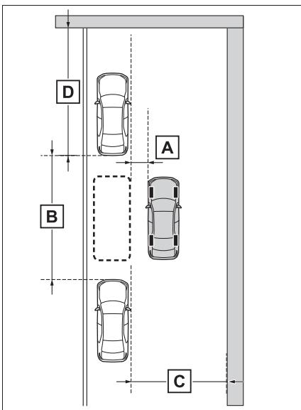
**A** 約 1m\***B** 約 7m 以上 \***C** 約 4.5m 以上 \***D** 約 8m 以上 \*
