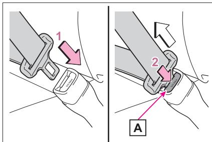
1 ベルトを固定するには、“力チッ”と音がするまでプレートをバックルに挿し込む
