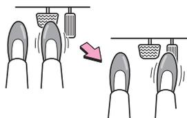
●後退するときは体をひねった姿勢となるため、ペダルの操作がしにくくなります。ペダル操作が確実にできるよう注意してください。
