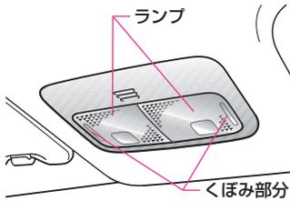
くぼみ部分を押しと押しした側のフロントパーソナルランプが点灯し、もう一度押しと消灯します。
