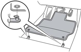
フロアマット付属の固定フック（クリップ）を使用して固定してください。詳しい固定方法はフロアマット付属の取扱書をお読みください。
