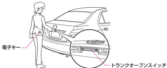
電子キーを携帯し、トランクオープンスイッチを押します。
