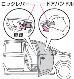
フロントドアはロックレバーを施錠側にして、ドアハンドルを引いたままドアを閉めます。リヤドアはロックレバーを施錠側にしてドアを閉めます。
