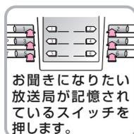
1~6までの**プリセットスイッチ**の1つを押します。記憶されている放送局が選択されます。
