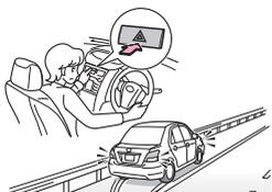
非常点滅灯（P.224の「非常点滅灯の使い方」参照）を点滅させながら、車を路肩に寄せ停車します。非常点滅灯は、故障などでやむを得ず路上駐車する場合、他車に知らせるため使用します。
