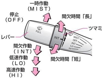
レバーを操作すると、左図のように作動します。
