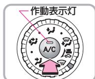
3 エアコンが作動していないときは**エアコンスイッチ**を押してエアコンを作動させます。
