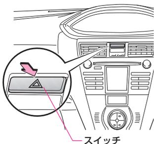
スイッチを押すと、すべての方向指示灯が点滅し、もう一度押すと消灯します。
