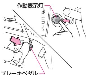
**3** 電子キー認識後、約5秒以内にブレーキペダルを踏んだまま“エンジン スタート ストップ” スイッチを押します。
