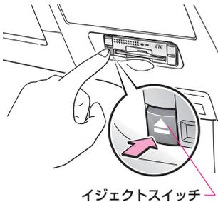
**1** 安全な場所に停車し、エンジンを停止する前に ETCユニットのイジェクトスイッチを押します。
