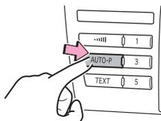
AUTO・Pスイッチを“ピツ”と音がするまで押し続けると、自動でプリセットスイッチに放送局がセットできます。
