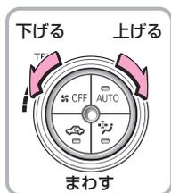
2 **温度調整ダイヤル**をまわして温度を設定します。
