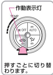
内外気切り替えスイッチを押して外気導入と内気循環に切り替えます。
