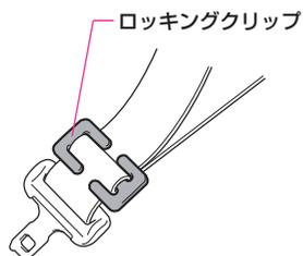
チャイルドシートにシートベルトの固定装置が備わっていない場合は、ロッキングクリップ（別売）を使用して固定します。
