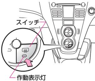
スイッチを押すと約15分間作動し、作動中にもう一度押すと停止します。
