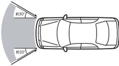
車両前方左右約30°以内の方向から乗員に重大な危害がおよぶような強い衝撃を受けたときに作動します。衝撃は車両前方・車両中央床部に取り付けられたセンサーで感知し、運転席・助手席SRSエアバッグをふくらませるようコンピューターに信号を送りSRSエアバッグが作動します。
