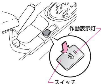
スイッチを押すと約15分間作動し、作動中にもう一度押すと停止します。
