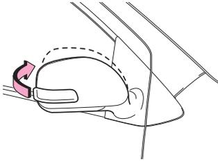
ドアミラー全体を車両後方に倒して格納します。
