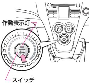
スイッチを押すと作動し、作動中にもう一度押すと停止します。
