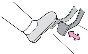
エンジンを始動し、ブレーキペダルをいっぱい踏み込み、床板とのすき間（P.367参照）を点検します。併せてペダルの感触に異常がないかを点検します。
