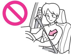
正しい運転姿勢でもシートベルトがねじれていたり、ゆるんでいたりと、確実にロックをしていない場合には、衝突したときなどに、シートベルトが十分な効果を発揮せず、重大な傷害におよぶか、最悪の場合死亡につながるおそれがあります。
