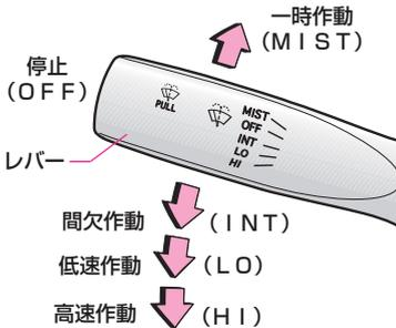
レバーを操作すると、左図のように作動します。
