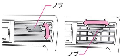
吹き出し口のノブを上下、左右に動かして好みの風向きに調整します。
