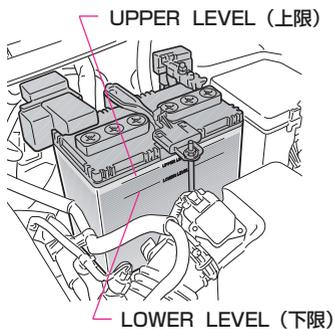
バッテリー液面が各液槽ともバッテリーのUPPER LEVEL (上限) と LOWER LEVEL (下限) のあいだにあるかを車両をゆするなどして点検します。
