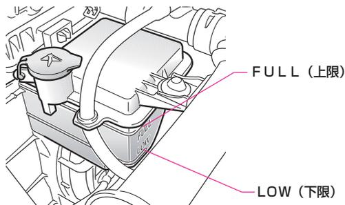
冷却水の量が、リザーバタンクのFULL (上限) とLOW (下限) のあいだにあるかを点検します。
