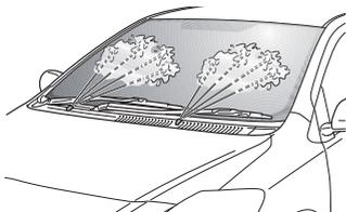
エンジンを始動し、ウィンドウウォッシャーを作動させ、噴射の向きおよび高さがワイパーの作動範囲のほぼ中央にあたるかを点検します。
