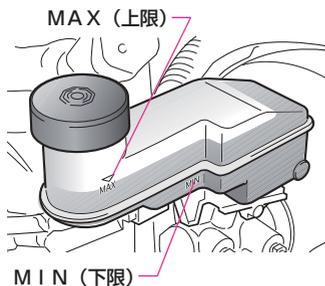
ブレーキフルードの量がリザーバータンクのMAX (上限) とMIN (下限) のあいだにあるかを点検します。
