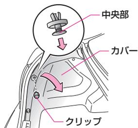
2 トランク内側のカバーを固定しているクリップを取りはずし、カバーをめくります。
