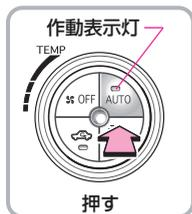
1 **AUTOスイッチ**を押して吹き出し口と風量を自動調整にします。
