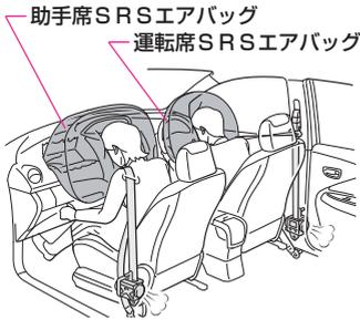
運転席・助手席SRSエアバッグは、運転者または助手席乗員に重大な危害がおよぶような強い衝撃を車両前方から受けたときにふくらみ、シートベルトが体を拘束する働きと併せて、乗員の頭や胸などに作用する衝撃を分散、緩和させる働きをするものです。
