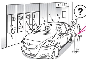
スマートエントリー & スタートシステムでの解錠ができないときは、ワイヤレスドアロックリモコン (P.133参照) またはメカニカルキー (P.116参照) を使って解錠してください。
