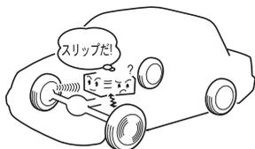
タイヤのスリップは4輪に取り付けられたセンサーからの信号を比較し、駆動輪のいずれかの信号が他の車輪より多い場合、スリップしているとコンピューターが判断します。それによって、スリップしているタイヤの駆動力を抑えようとブレーキをかけたり、エンジンの出力を一時的に抑えたりして、スリップを抑制させます。
