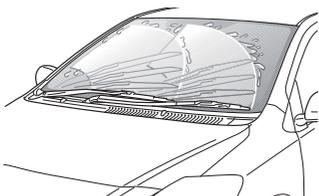
エンジンを始動し、ウィンドウウォッシャーでガラスをぬらした状態にして、ワイパーを作動させ、「間欠作動」「低速作動」「高速作動」「一時作動」の各作動が良いか、拭き取り状態が良いか点検します。
