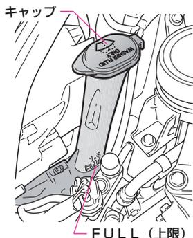
ウォッシャータンク側面から、液面を確認します。ウォッシャー液が不足しているときは、ウォッシャー液を補給してください。
