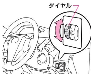
ダイヤルをまわすと、ヘッドランプの光軸（光の照らす方向）を下向きに調整できます。
