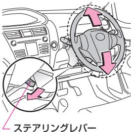
ステアリングレバーを押し下げ、ハンドルを上下に動かし適切な位置にして、ステアリングレバーを引き上げると固定されます。
