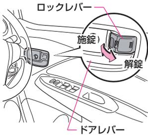
ロックレバーを前方に押し込むと施錠、後方に引き出すと解錠されます。
