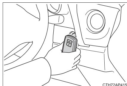
③ ドライブモニターディスプレイ装着車：オートマチック車はブレーキペダル、マニュアル車はクラッチペダルをしっかりと踏み込んで、スマートエントリー＆スタートシステム表示灯が緑色に点灯していることを確認する
