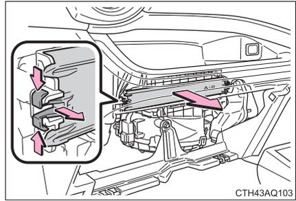
6 フィルターを取りはずし、新しいフィルターと交換する
