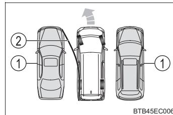
走行中にサイドセンサーで静止物を検知します。車両が移動して静止物がサイドセンサーで検知できない位置にあった場合も、車両の位置を計算することで静止物の位置を算出し、車両の経路内に静止物がある場合に、巻き込み警報機能が作動します。
