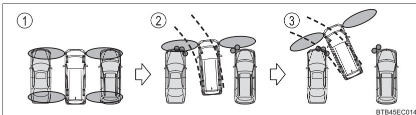
●：サイドセンサーで検知した静止物
