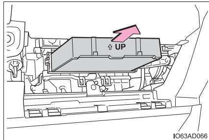
**7 フィルターを取りはずし、新しいフィルターと交換する**
