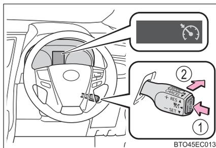
定速制御モードに切りかえると、クルーズコントロール表示灯が点灯します。定速制御モードから車間制御モードにもどすには、再度レバーを前方に約 1 秒間押し続けます。
