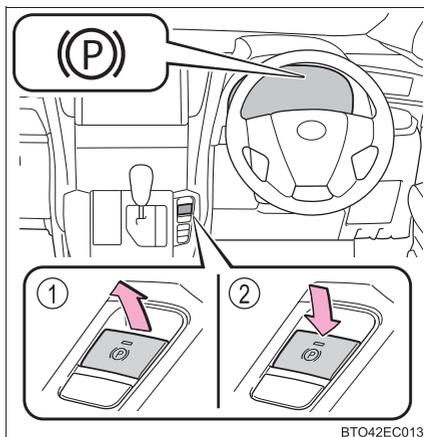
パーキングブレーキ表示灯が点滅した場合は、再度スイッチを操作してください。(→P. 489)
