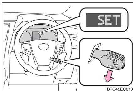
車速が約 50km/h 未満で先行車が検知できるときに操作をすると、設定速度を 50km/h として先行車に追従走行をします。
