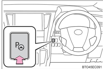
パワースイッチが ON モード、シフトレバーが P、R 以外で車速が約 15km/h 以下のとき、IPA スイッチを押すごとに、次のように機能が切りかわります。
