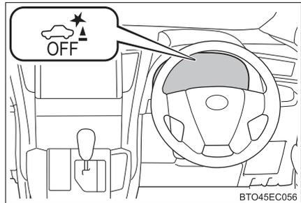
OFF (停止) に切りかえて、インテリジェントクリアランスソナーを停止させた場合、再度、マルチインフォメーションディスプレイの「設定」から
