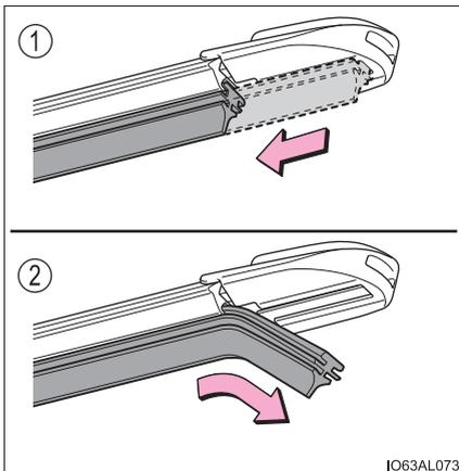
新しいワイパーゴムを取り付けるときは、逆の要領で作業を行います。取り付け後は、ワイパーゴムの先端がキャップの端まで確実に届いていることを確認してください。
