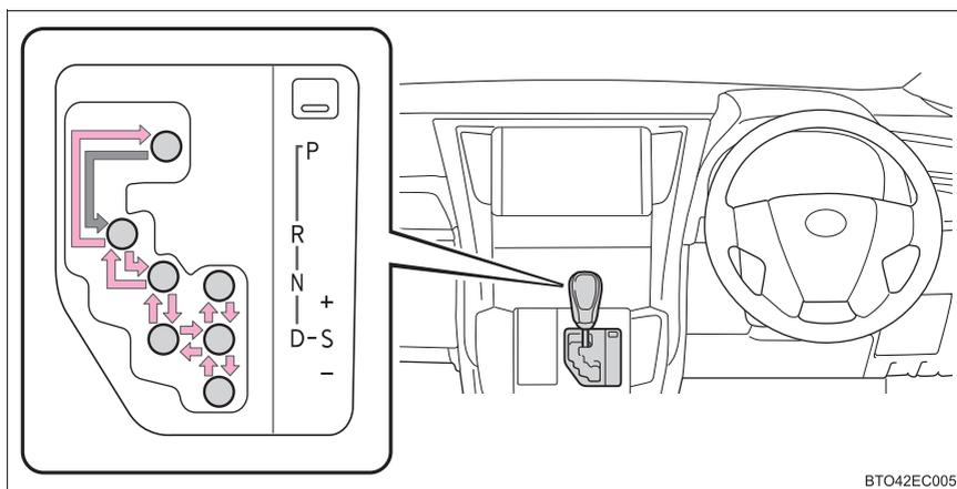
← パワースイッチが ON モードの状態、ブレーキペダルを踏んだまま操作します。
