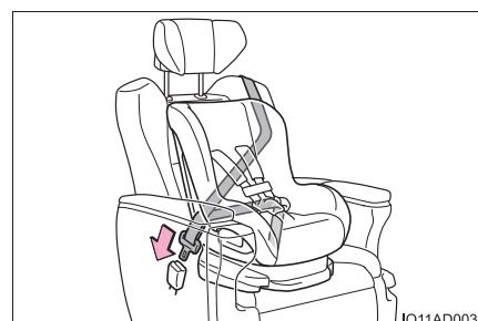
**5** チャイルドシートにシートベルトの固定装置が備わっていない場合は、ロッキングクリップ（別売）を使用して固定する
