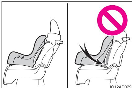
\*<sup>3</sup> ヘッドレストとチャイルドシートが干渉してチャイルドシートが正しく取り付けられない場合、ヘッドレストの取りはずしが可能なときは、ヘッドレストを取りはずしてください。
