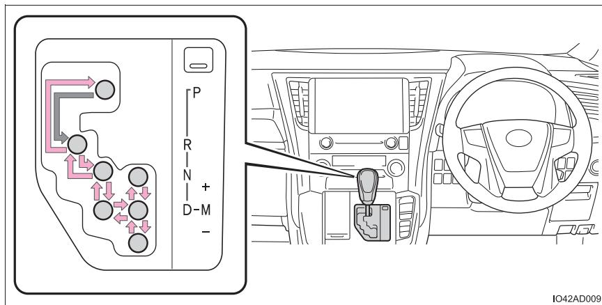
← エンジンスイッチがイグニッション ON モードの状態で、ブレーキペダルを踏んだまま操作します。
