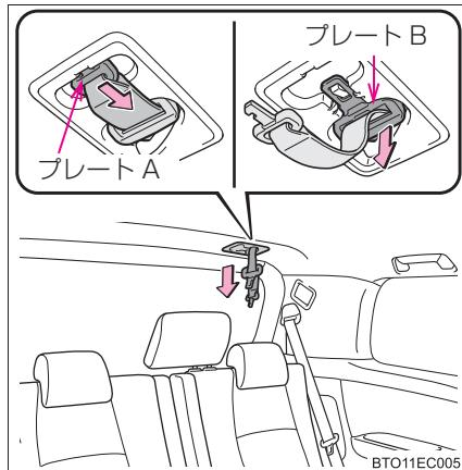
② ベルトを固定するには、プレートA、プレートBの順に“カチッ”と音がするまでプレートをバックルに挿し込む
