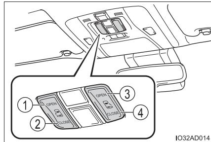
開閉作動中に再度スイッチを押すと、作動が停止します。
