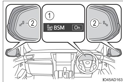
ドアミラーの死角領域に車両を検知したとき、または後方からその死角領域に急速に接近してくる車両を検知したときは、検知した側のドアミラーインジケーターが点灯します。検知した側に方向指示レバーを操作している場合は、ドアミラーインジケーターが点滅します。
